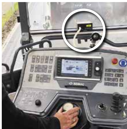
Arbeitsplatzmessung am Steuerstand des Straßenfertigers
