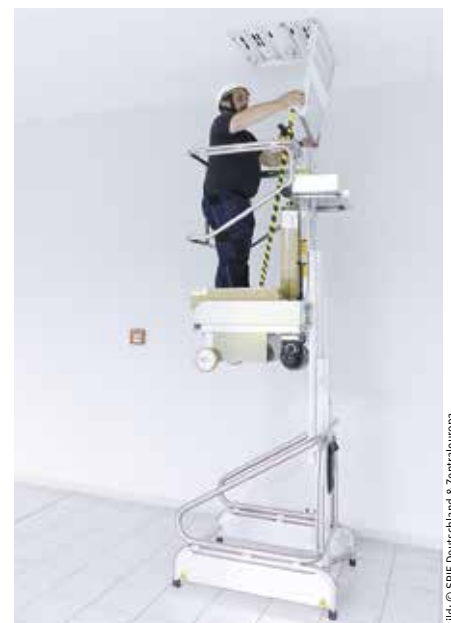
Einfache und sichere Durchführung von Wartungsarbeiten mit der Ein-Personen-Hubarbeitsbühne
