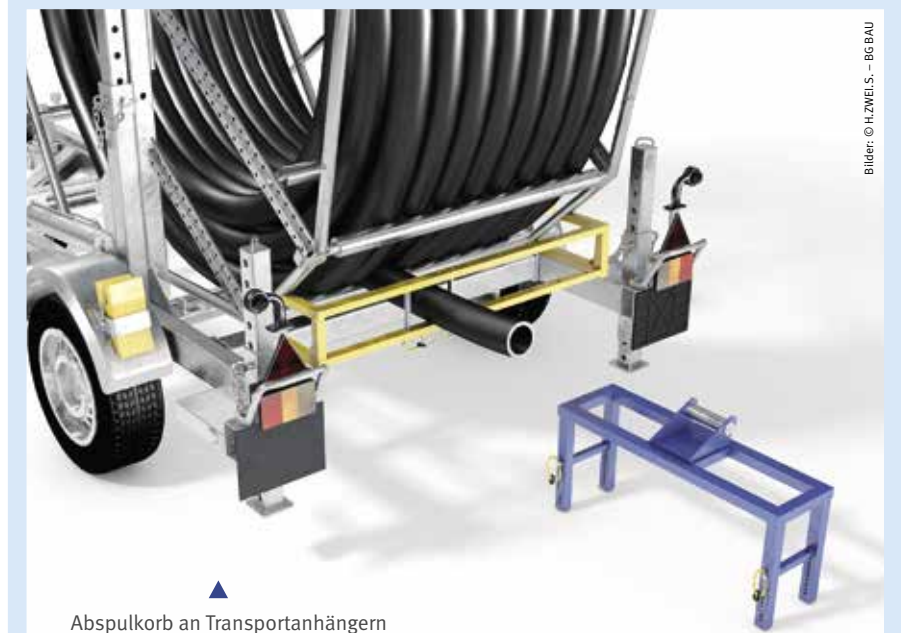
▲ Abspulkorb an Transportanhängern zum Abspulen von Rohrtrommeln
