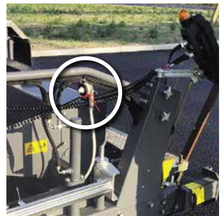
Arbeitsplatzmessung am Außenbedienstand des Straßenfertigers
