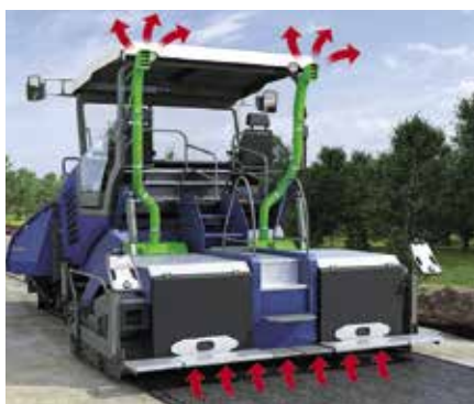
Absauganlage am Straßenfertiger
